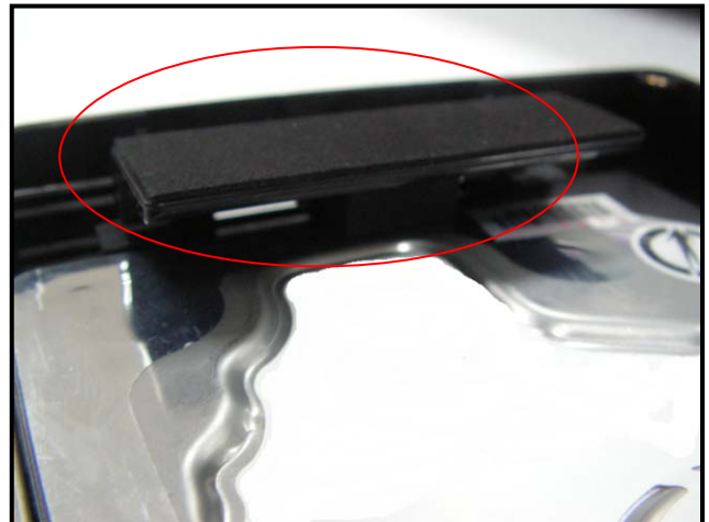
Festplatte mit geschlossenen Festplattenbügel und Gummi Pad. (3.5" Festplatte mit halber Bauhöhe)
